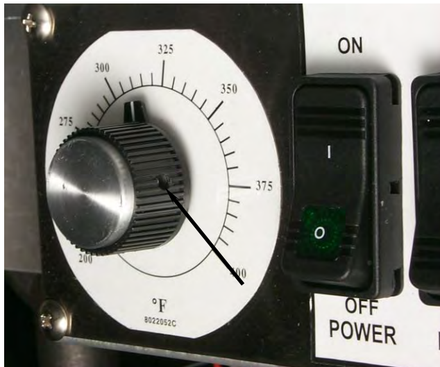
Ubicación del tornillo de fijación de la perilla de control (flecha: contador instalado en la perilla).
