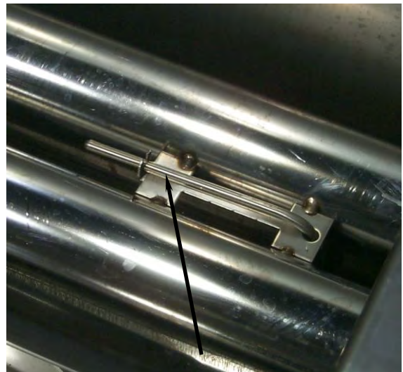
Sonda de termostato electrónico en la olla de freír (flecha).
